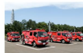
発電所の全ての交流電源を失い、電動の注水設備が使えなくなったとしても、原子炉建屋に接続し、原子炉や使用燃料プールに注水を行います。同時に使用不能とならないよう、加圧給水を行います。
