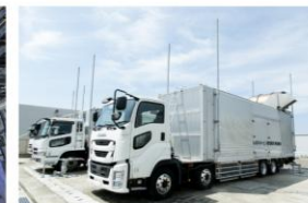
空形式スタービン発電機は、軽油の燃焼方式でタービンを回して電気を発生する発電機を搭載した車で、発電所内の津波の影響を受けにくい場所に配置しています。
