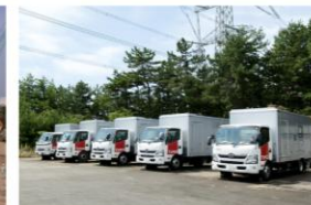
電源車は、必要時に必要な場所に移動して電力を供給する車で、発電所内の津波の影響を受けにくい場所に配置しています。
