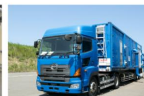
原子炉の熱交換器が壊れた場合に、原子炉や原子炉燃料貯留罐を冷却する設備で、これを備えることで、少なくとも約10日間は大気へ放射性物質の放出を減らすことができます。
